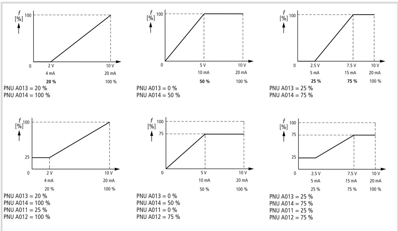
Figure 141: Analog actual value signal matching
