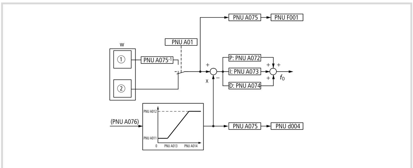
Figure 140: PID control parameters
